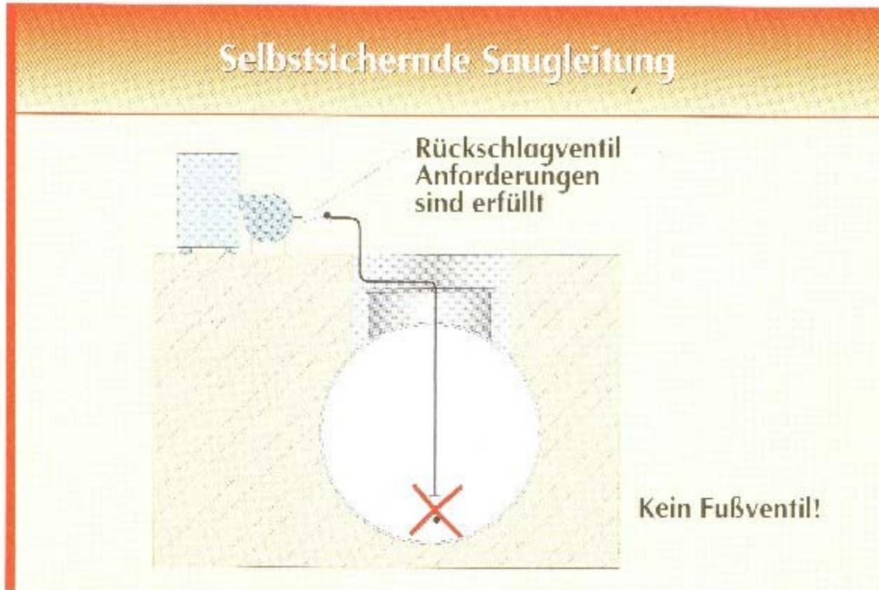
Saugleitung durch elektr. Ventil (Aushebersicherung) gesichert
