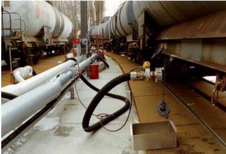
*Entleerung von Eisenbahn-Kesselwagen: Anschlusschlauch mit Sicherheitstrennkupplung, Tropfleckagen werden mit einer mobilen Auffangwanne erfasst.*
