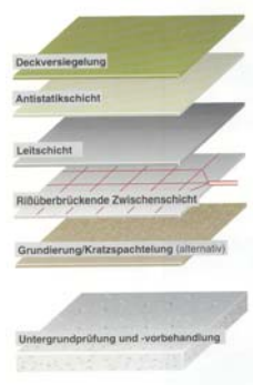
Beispiel des Aufbaus einer möglichen Abdichtfläche
